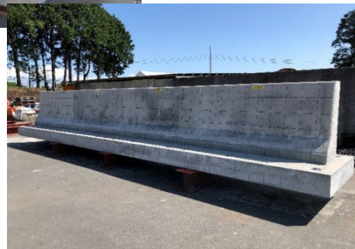
試験用壁高欄（組立後）
