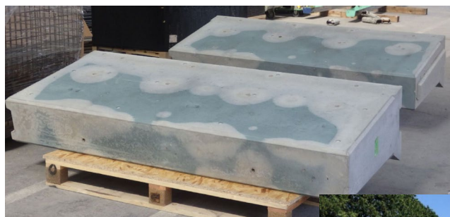
試験用壁高欄（脱型直後）
